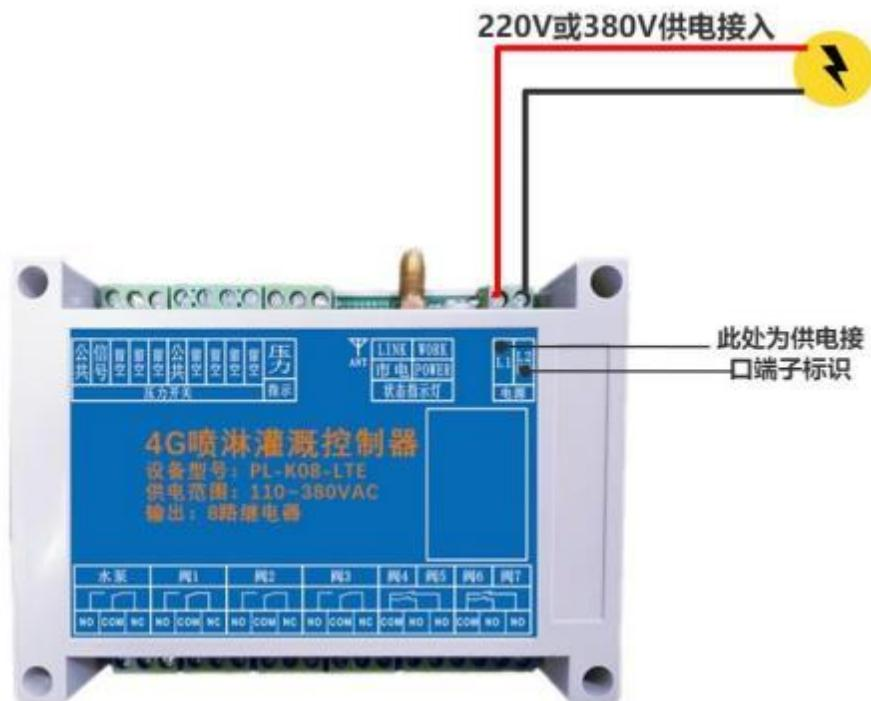
在电源线正常连接后，会有指示灯亮起，一般是通电正常，
