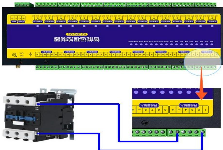
一般常用于监测限位、浮球、红外等开关信号以及可以接自复位式按钮开关，接线如下所示：
