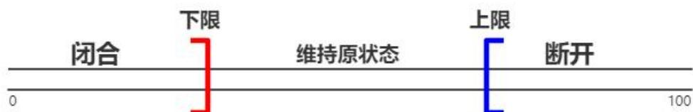
**④输入跟随:** 选择此模式后开关量触发时继电器闭合，开关量无触发时继电器则断开。
