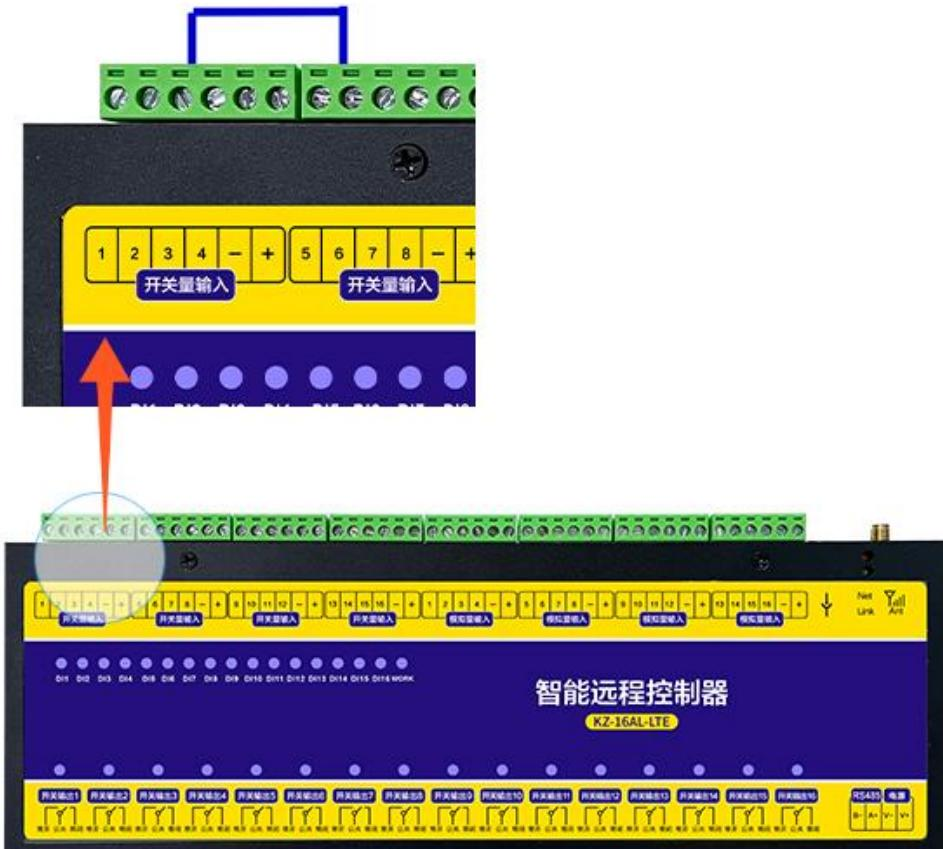
一般常用于监测交流接触器的常开辅助触点信号来作为状态反馈，接线如下所示：
