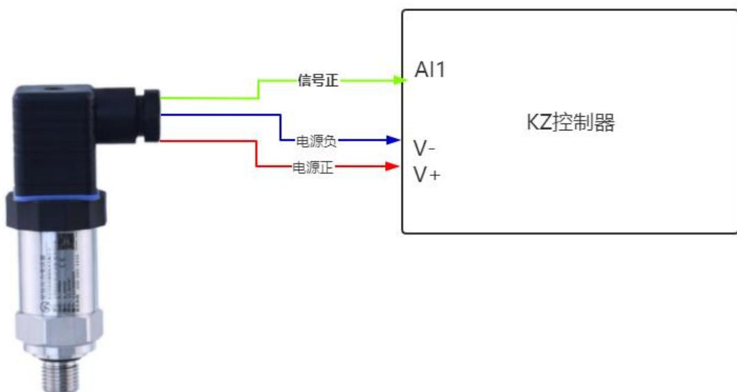
四线制模拟量传感器接线到控制器的第一路模拟量采集，需要：
