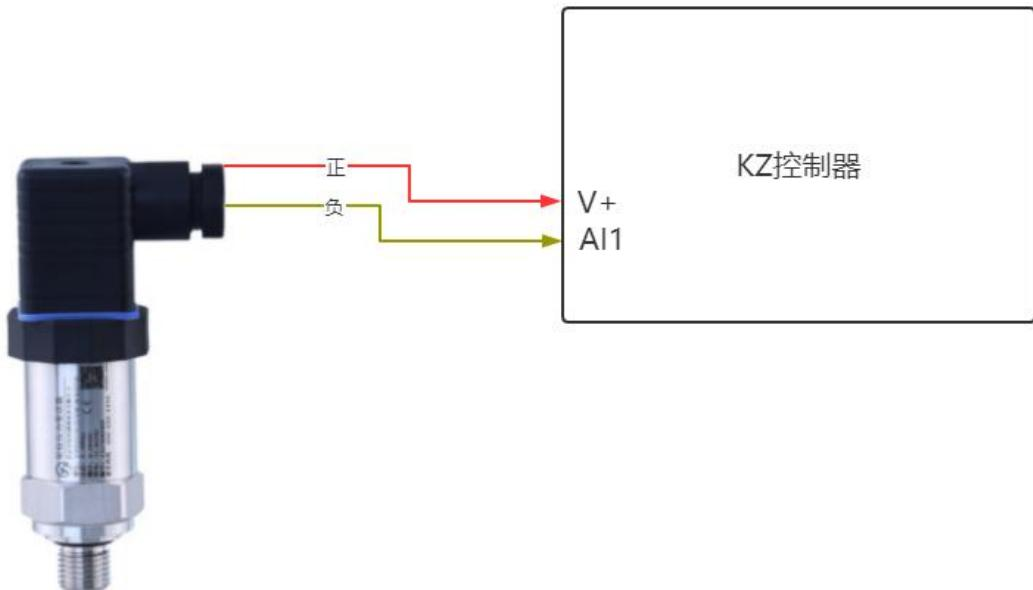
三线制模拟量传感器接线到控制器的第一路模拟量采集，需要：
