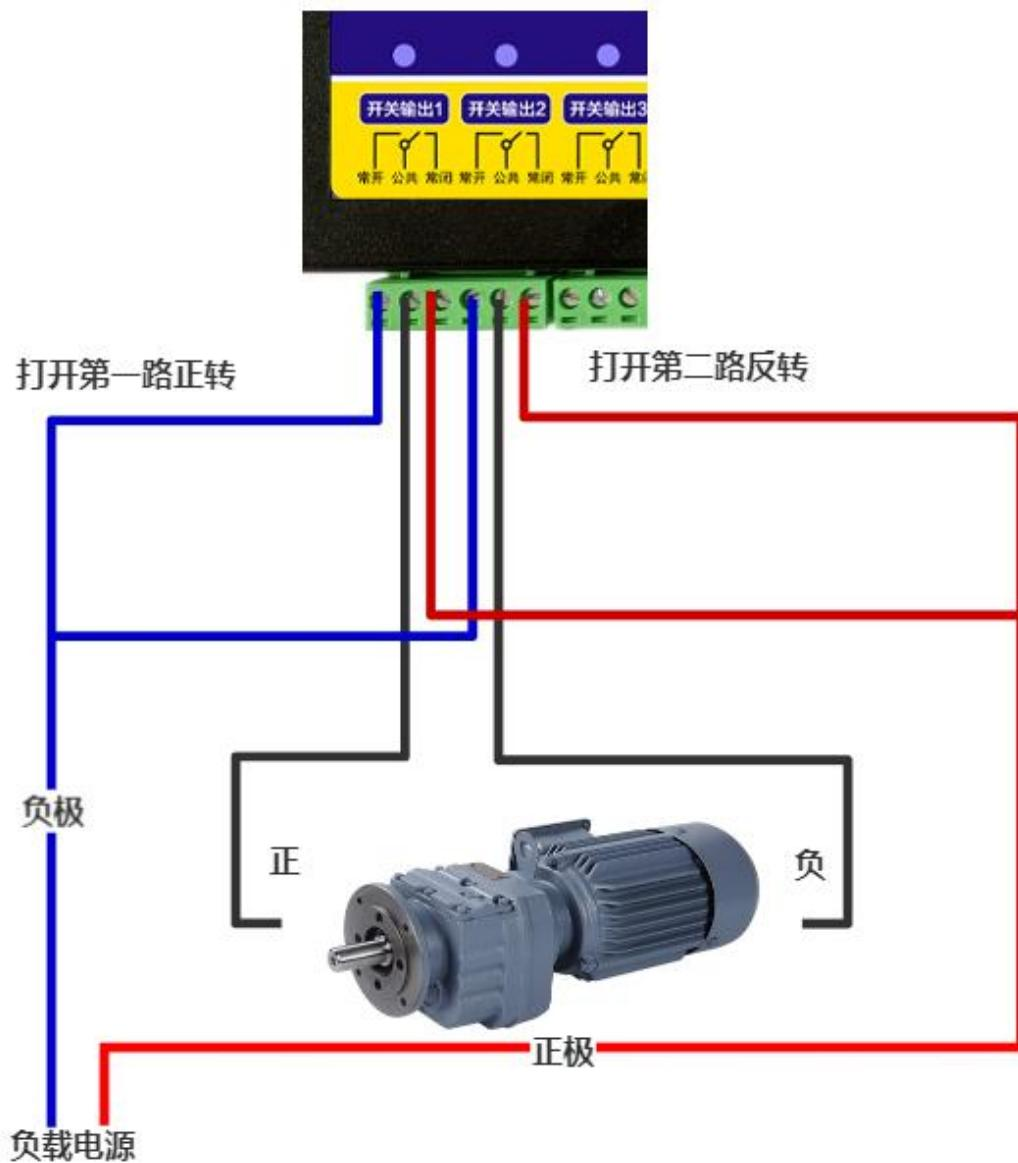
下图为用第一二路通道控制三线制电机正反转，第一路打开是正转，第二路打开是反转，同时打开或者关闭电机不转：
