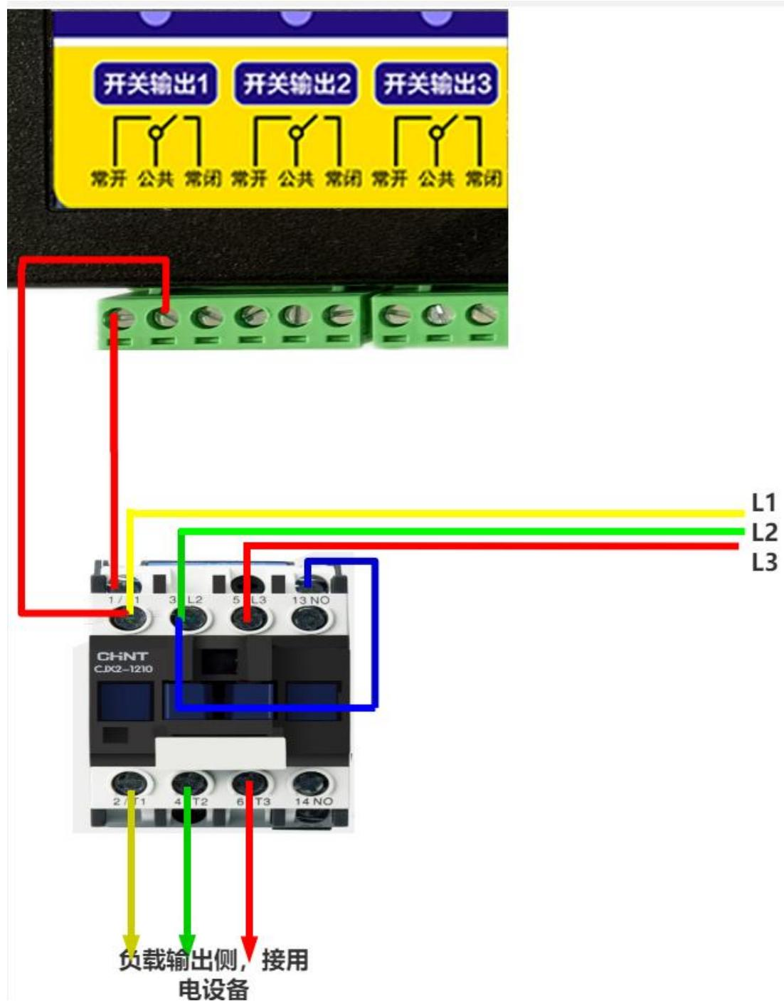
下图为用第一二路通道控制两线制电机正反转，第一路打开是正转，第二路打开是反转，同时打开或者关闭电机不转：
