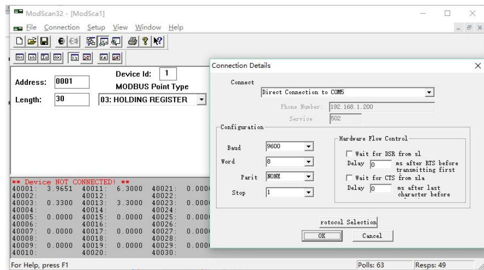
在连接好电源和 RS485 信号线，并打开调试软件后，可对本产品进行控制测试。本文档以一个两线制压力传感器为例，进行测试。
