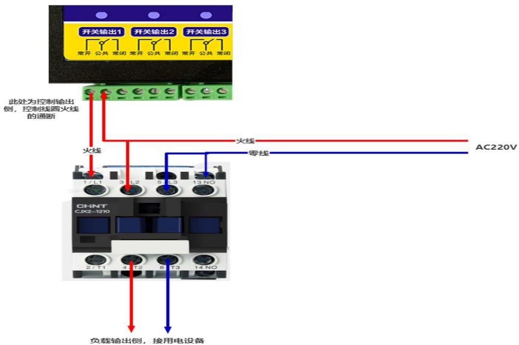
下图为用第一路通道控制 220V 线圈的交流接触器并带 380V 负载：
