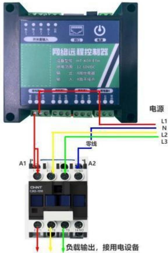
下图为用两路通道控制两线制电机正反转，第五路打开是正转，第六路打开是反转，同时打开或者关闭电机不转：
