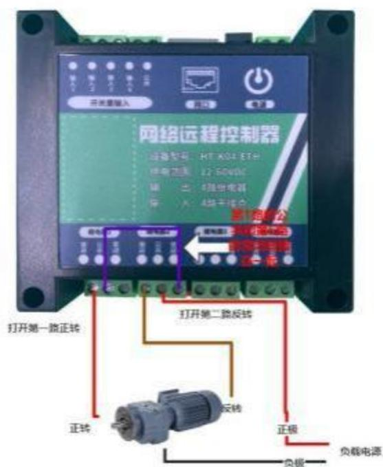
下图为用两路通道控制启动柜的启动和停止按钮（适用于点动自保持线路），第一路常开点和公共点并联接入启动按钮，第二路常闭点和公共点串联接入停止按钮
