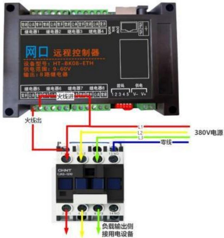
下图为用两路通道控制**两线制电机正反转**，第五路打开是正转，第六路打开是反转，同时打开或者关闭电机不转：
