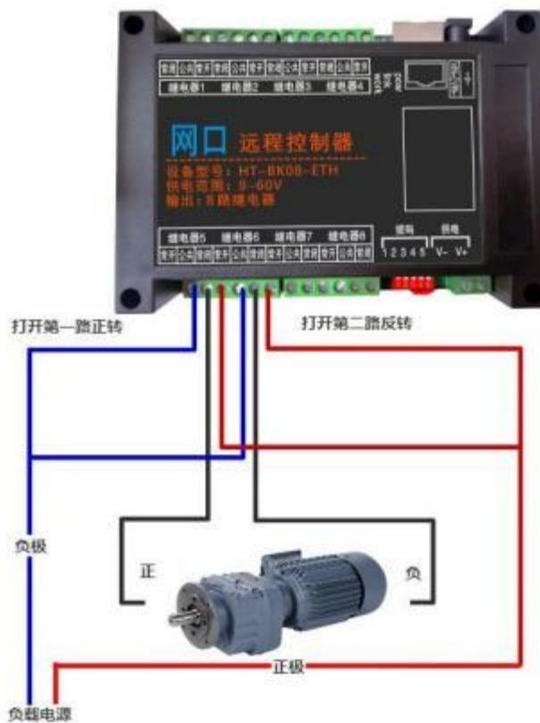
下图为用两路通道控制**三线制电机正反转**，第一路打开是正转，第二路打开是反转，同时打开或者关闭电机不转：
