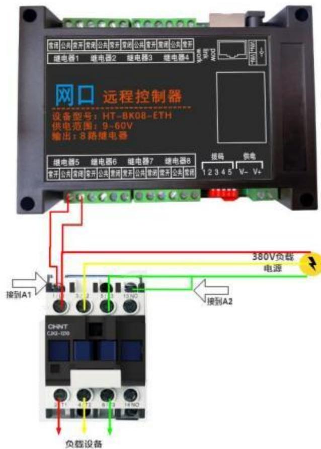
下图为用一路通道控制 220V 线圈的交流接触器并带 380V 负载：
